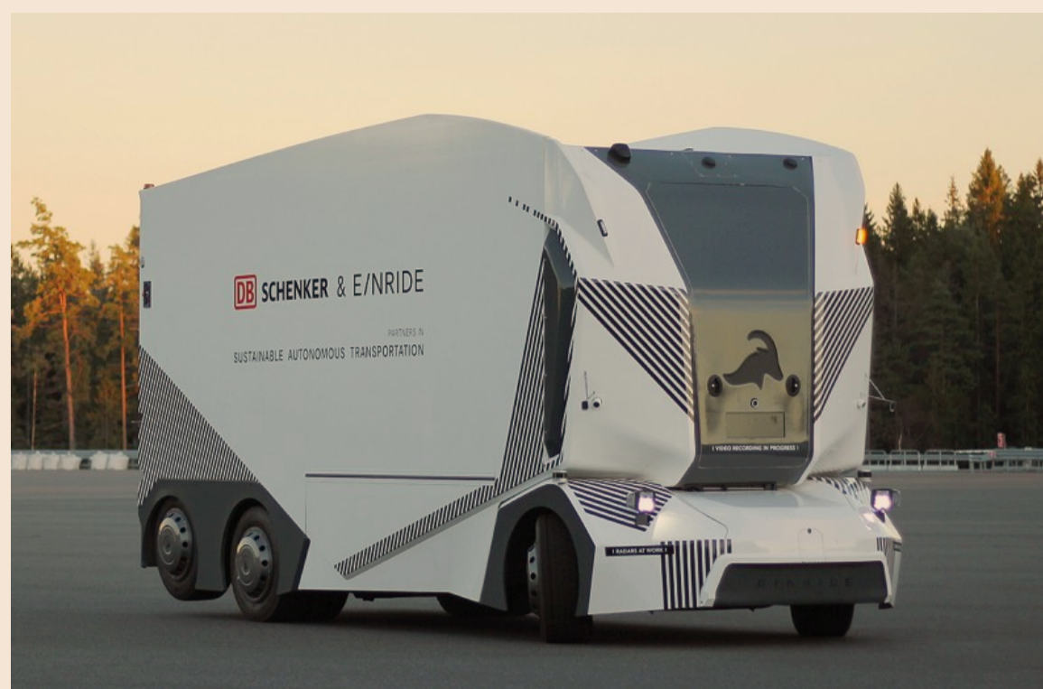
Hi-tech. A sinistra Einride, veicolo elettrico senza conducente con controllo da remoto. Sopra Uptis, prototipo di copertura «senza aria» sviluppato da Michelin
