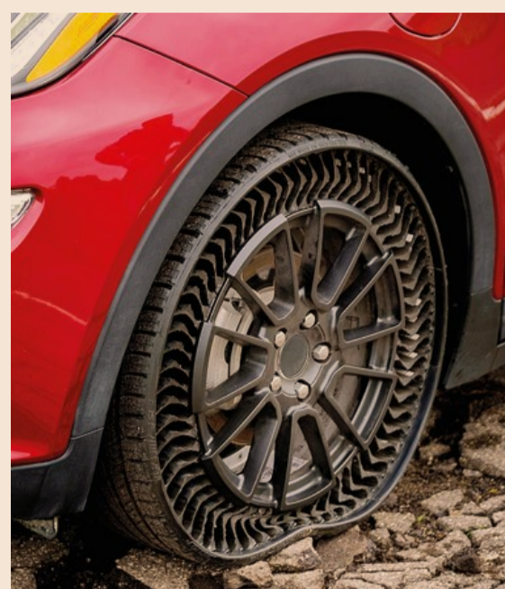
Hi-tech. A sinistra Einride, veicolo elettrico senza conducente con controllo da remoto. Sopra Uptis, prototipo di copertura «senza aria» sviluppato da Michelin
