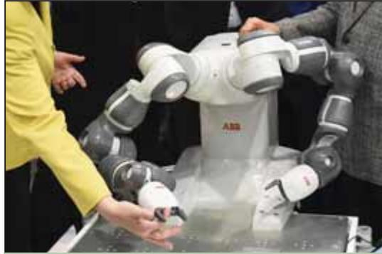
Un modello di Cobot, cioè di robot che collabora con il lavoratore
